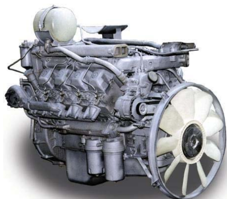
КАМАЗ-740.30.260 (191 кВт), V8, Мкр = 110 кг*м EURO-2
