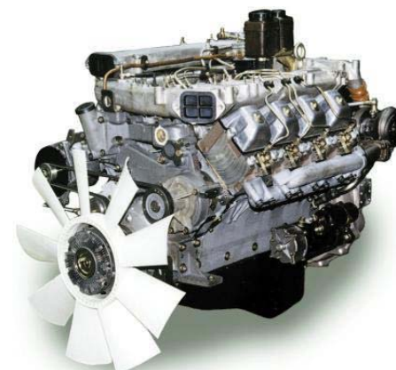
КАМАЗ-740.60.360 (265 кВт), V8, Мкр = 160 кг*м EURO-3
