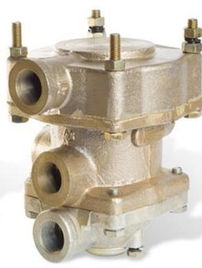
Клапан управления тормозами прицепа с двухпроводным приводом
