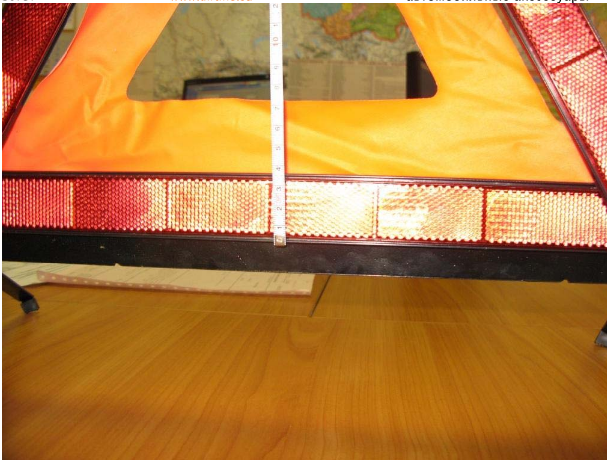
Светоотражающий элемент (нижний) располагается по краю в пределах полосы, одинаковой шириной 34 мм, что в пределах нормы - 25 – 50 мм.
