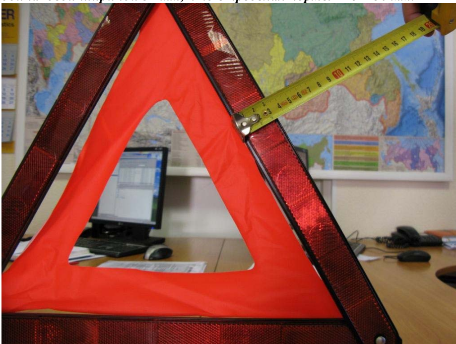
Светоотражающий элемент (правый) располагается по краю в пределах полосы, одинаковой шириной 34 мм, что в пределах нормы - 25 – 50 мм.
